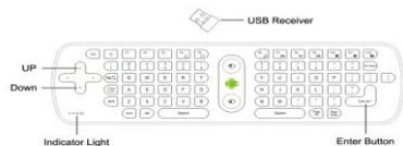
2. Kada LED dioda počne da treperi, istovremeno priključite USB risiver u USB konektor na Vašem uređaju, kako bi započeo process inicijalizacije. Nakon 5 sekundi, LED dioda će prestati da treperi, što znači da je RC11 uspešno podešen na početne parametre.
