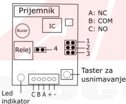
Na slici je šematski prikaz pločice:
